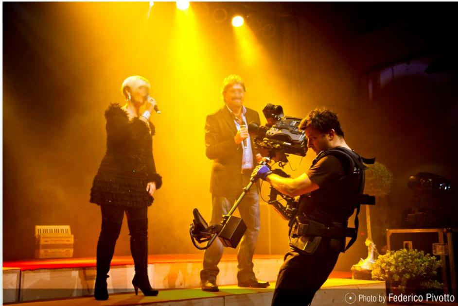
Al 95% in alluminio, è composto da una colonna in acciaio inox di diametro 20 mm regolabile in altezza, da una slitta regolabile porta telecamera, da una impugnatura con snodo a 3 assi regolabile in altezza, da un porta monitor regolabile ed adattabile a diversi modelli e da un porta batterie regolabile ed adattabile a diversi modelli.
