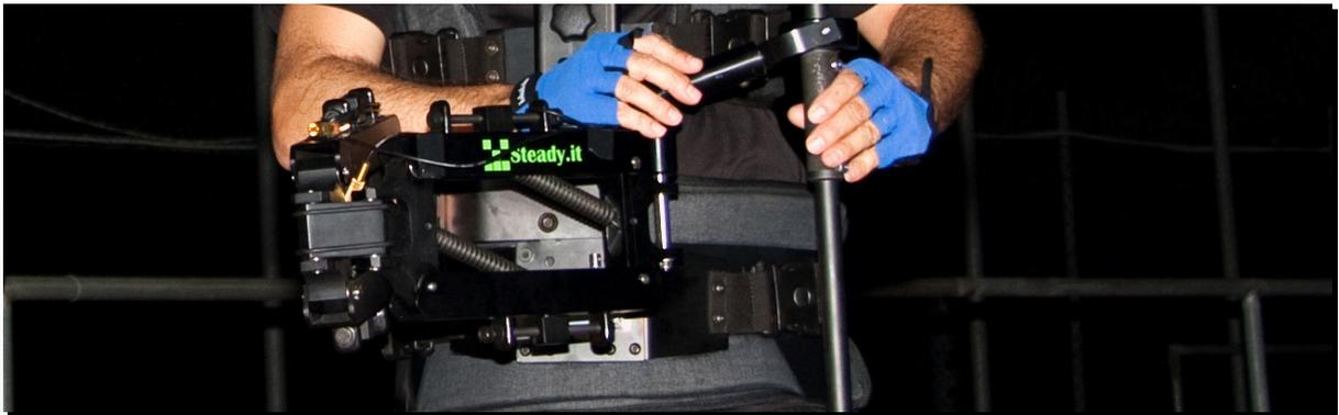
La costruzione dello schelomentro è realizzata in lega d'alluminio da 4 mm. con alta resistenza alla torsione, per portare telecamere fino a Kg. 12.
